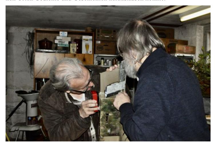
Die Inspektion zeigte, dass an verschiedenen Orten Münzen verklemmt waren, dass die ganze Mechanik ziemlich verharzt war und dringen gereinigt und mit speziellem Öl behandelt werden musste.
