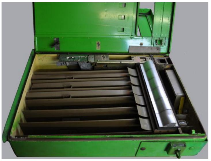
Alle Teile im Innern des Automaten sind im Originalzustand. Einzig drei Schrauben mit den zugehörigen Muttern sind neu, sie waren zu verrostet um sie noch einmal verwenden zu können. Einzig die schwarze Gummiabdichtung rundum ist neu.
