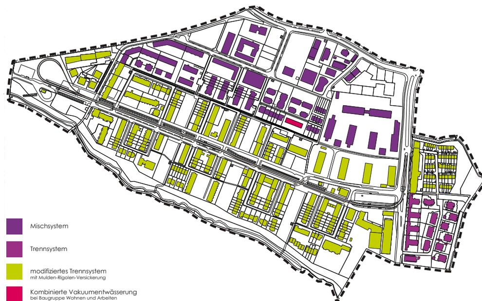
Abb. 27: Entwässerungssysteme auf dem Vauban Gelände
